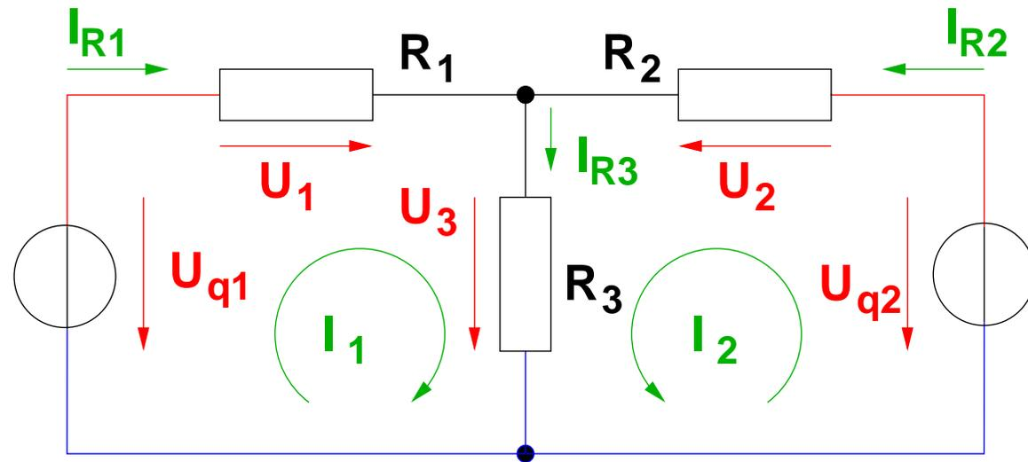
Abbildung 3.2.1: T-Netzwerk mit zwei Spannungsquellen
